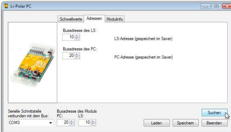
Beim Li-Polar LS handelt es sich um ein busfähiges System: an einer USB2SYS-Leitung können mehrere Li-Polar LS betrieben und angesteuert werden. Soll nur ein Li-Polar LS verwendet werden, sollten die vorgegebenen Einstellungen der Adressen nicht verändert werden.
